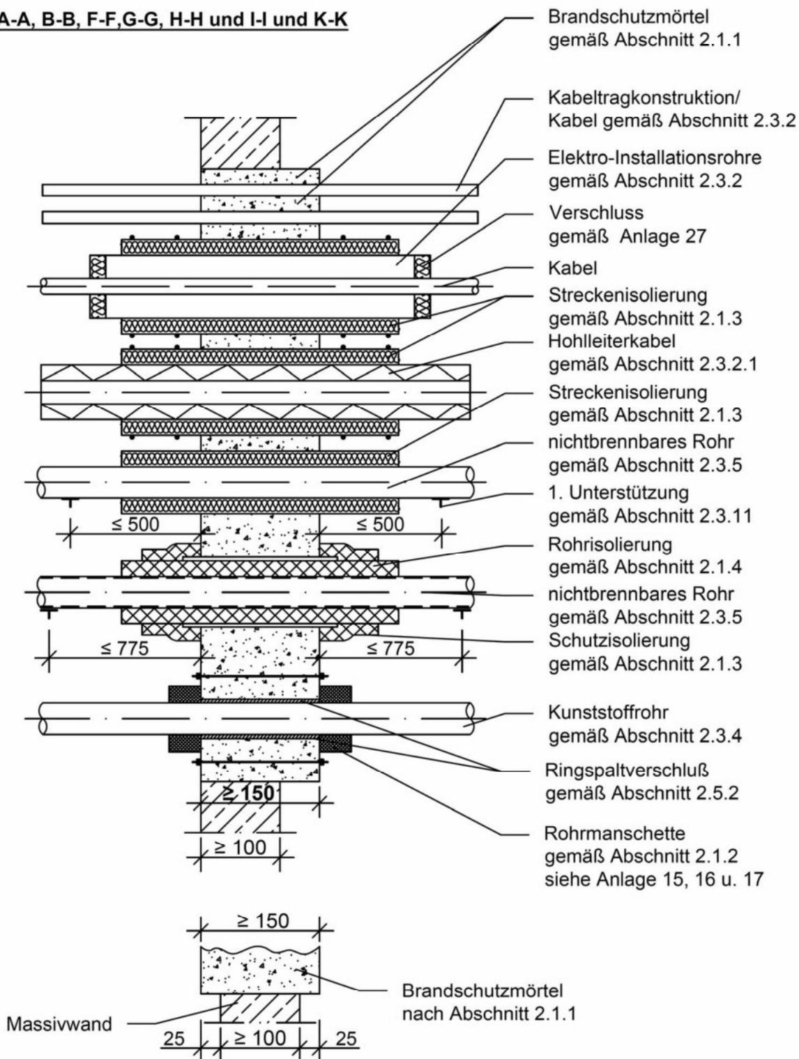
Feuerwiderstandsfähige Abschottung für elektrische Leitungen und/oder Rohrleitungen aus Kunststoff oder Metall "Novasit COMBI 90"
