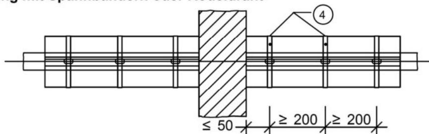
Feuerwiderstandsfähige Abschottung für elektrische Leitungen und/oder Rohrleitungen aus Kunststoff oder Metall "Novasit COMBI 90"
