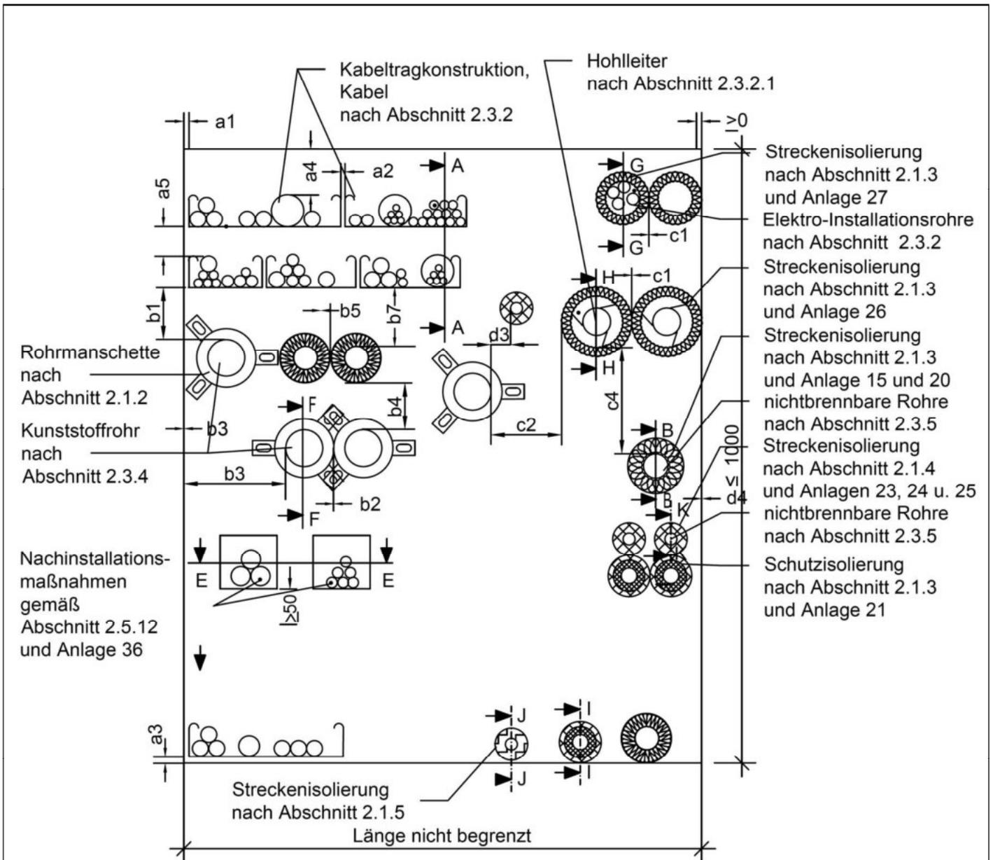
**Maximale Abmessungen der Abschottung**
