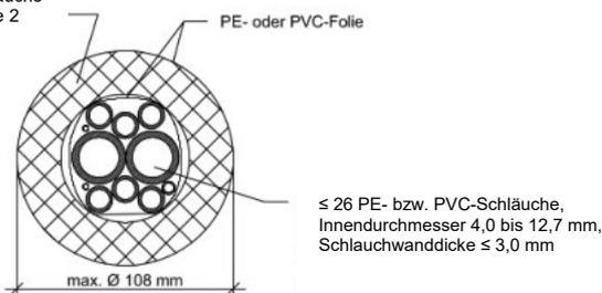
≤ 26 PE- bzw. PVC-Schläuche, Innendurchmesser 4,0 bis 12,7 mm, Schlauchwanddicke ≤ 3,0 mm
