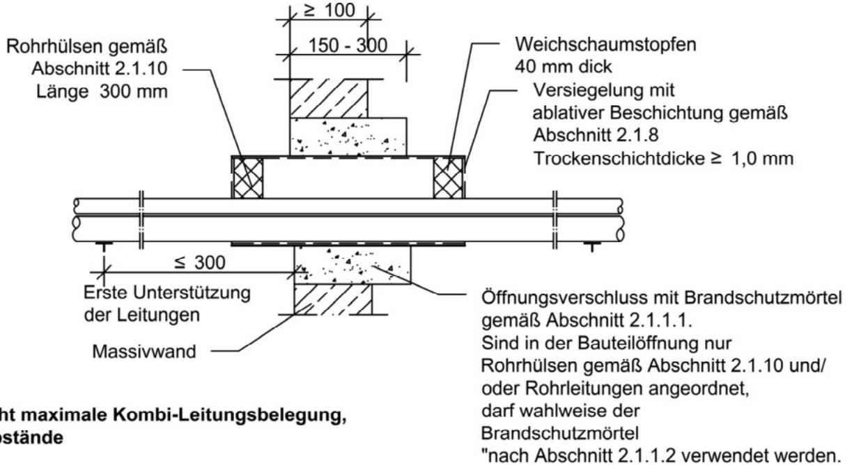
Kunststoffrohre mit Außen-Ø  $\leq 32$  mm
