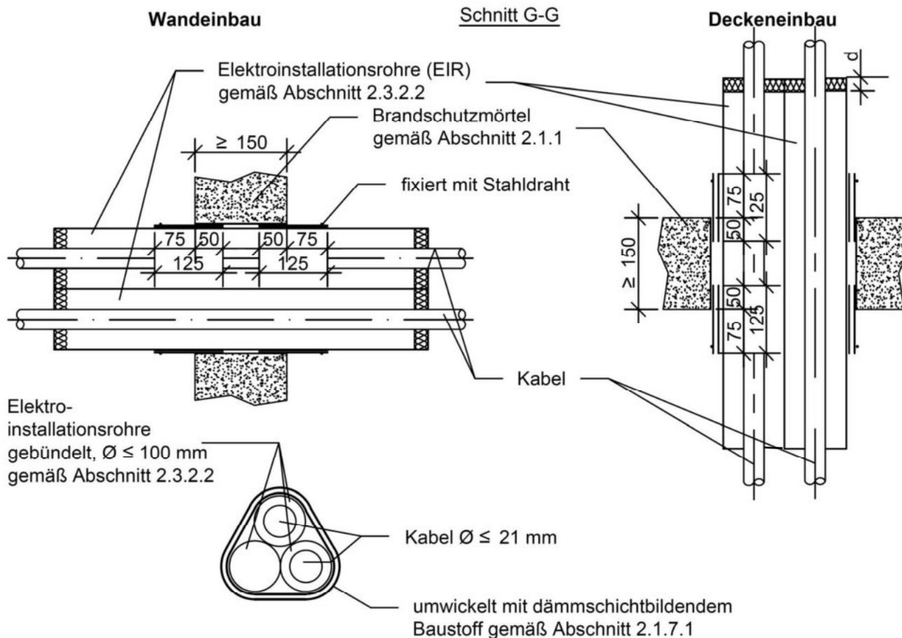
Einbau von starren und biegsamen Elektroinstallationsrohren (EIR) nach DIN EN 61386 bzw. DIN EN 50086 aus Kunststoff- oder Stahlqualitäten
