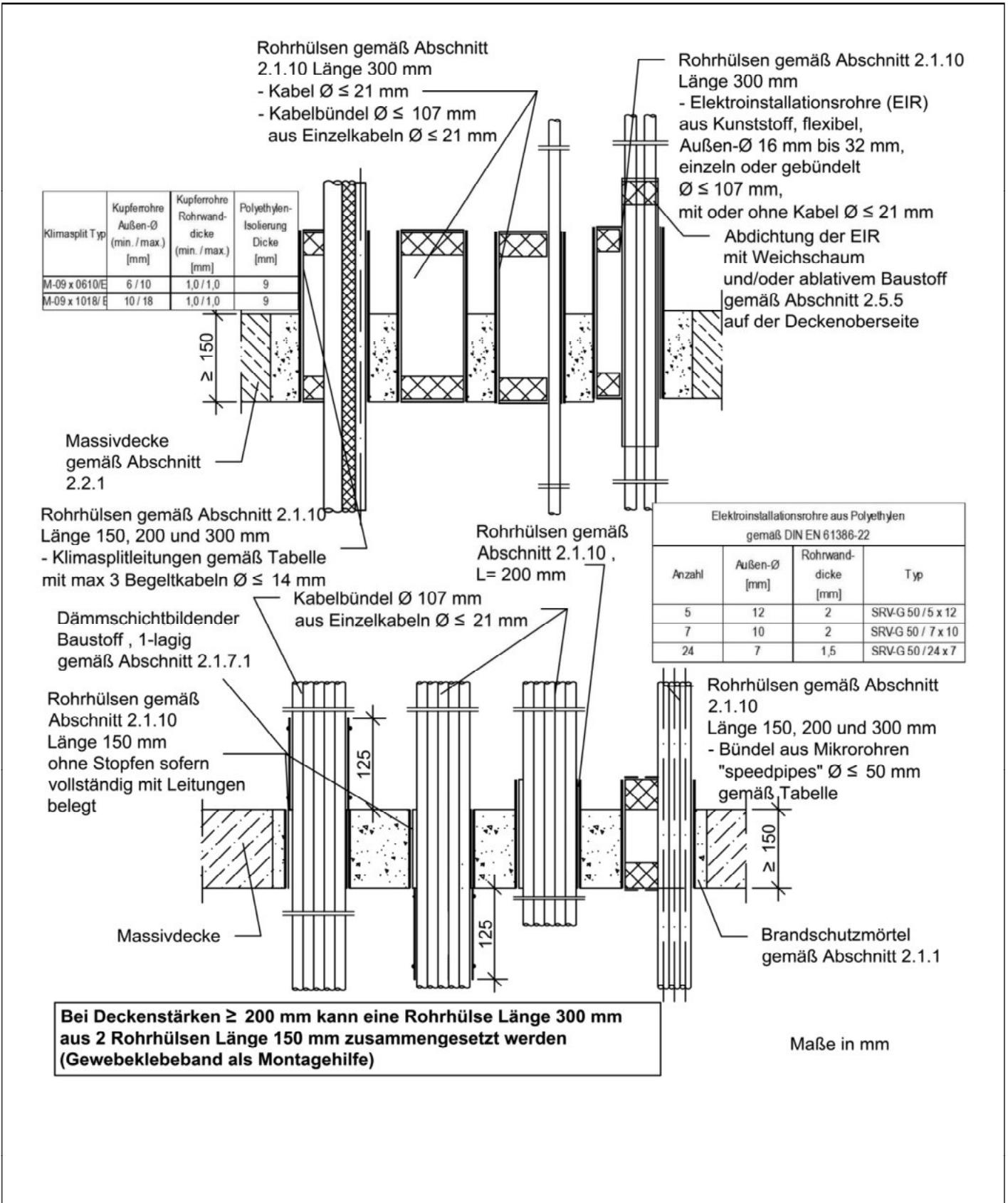
Feuerwiderstandsfähige Abschottung für elektrische Leitungen und/oder Rohrleitungen aus Kunststoff oder Metall "Novasit COMBI 90"
