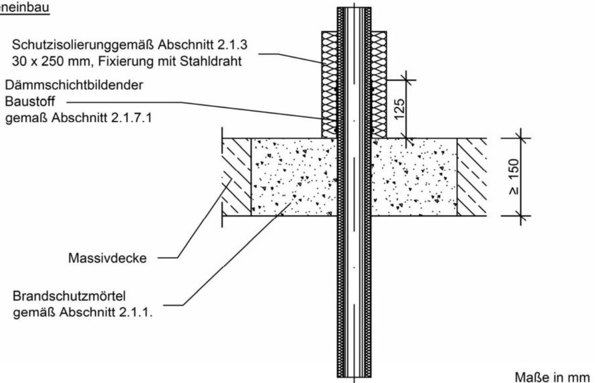
Feuerwiderstandsfähige Abschottung für elektrische Leitungen und/oder Rohrleitungen aus Kunststoff oder Metall "Novasit COMBI 90"
