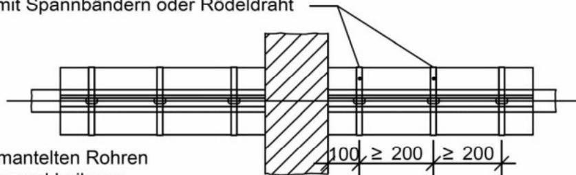
Abstand zwischen den ummantelten Rohren und zwischen Ummantelung und Laibung, bei Wand- und Deckeneinbau  $\geq 0$  mm
