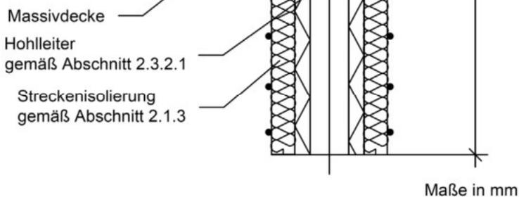
Feuerwiderstandsfähige Abschottung für elektrische Leitungen und/oder Rohrleitungen aus Kunststoff oder Metall "Novasit COMBI 90"
