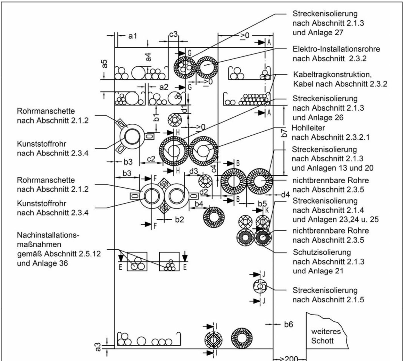
**Maximale Abmessungen der Abschottung:**
